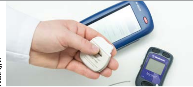
„Schmerzschrötmacher“: Elektrode und Neurostimulator in der Hand des Arztes, hinten das Programmiergerät; mit dem Bediengerät (rechts) dosiert der Patient die Stromimpulse.
